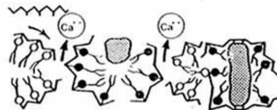
D) Le zone destabilizzate assumono una conformazione esagonale
